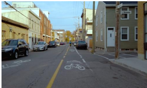
Bande cyclable à contre-sens Présence de stationnement sur rue Rue résidentielle Limite de vitesse à 30 km/h
