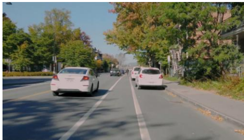
Bande cyclable unidirectionnelle Présence de stationnement sur rue Rue locale Limite de vitesse à 50 km/h
